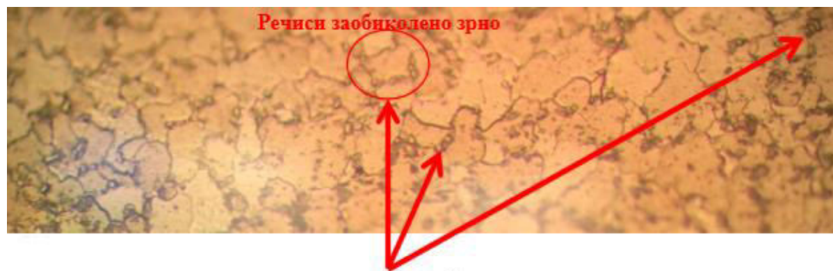
Интензивна коагулација на карбиди по границите на зрната (x500)
