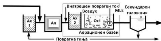
Слика 5.12. Процеси со активна тиња за отстранување на фосфорот
