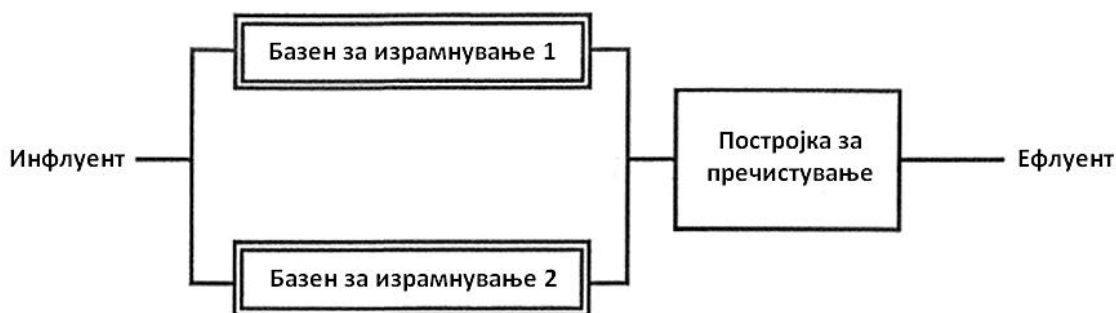
Слика 9.1. Систем за израмнување со наизменично пренасочување на протокот [8]
