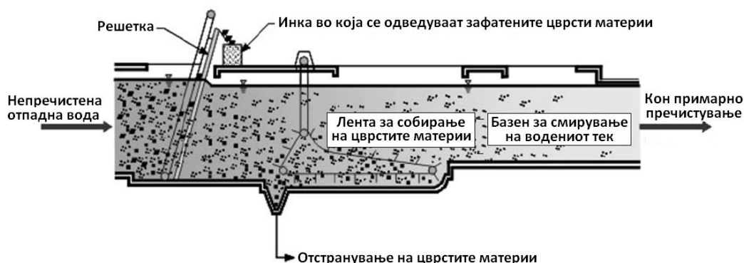
Слика 2.1. Шематски приказ на прелиминарното пречистување на отпадните води
