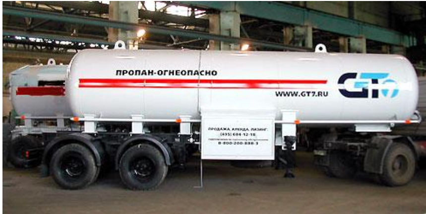
Слика 39. Авто-цистерна - носач за транспорт на пропан со капацитет од 20 тони
