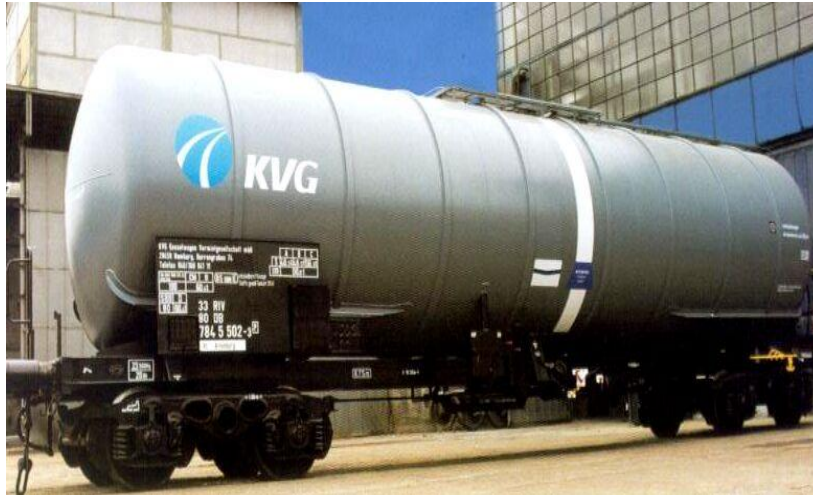
Слика 37. Вагон-цистерна за ТНГ со 95 m 3 капацитет (геометриски волумен)
