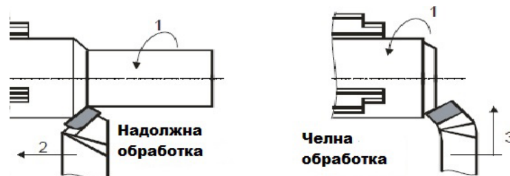
Сл.7.1. Главно (1) и помошно (2,3) движење при обработките со стругање
