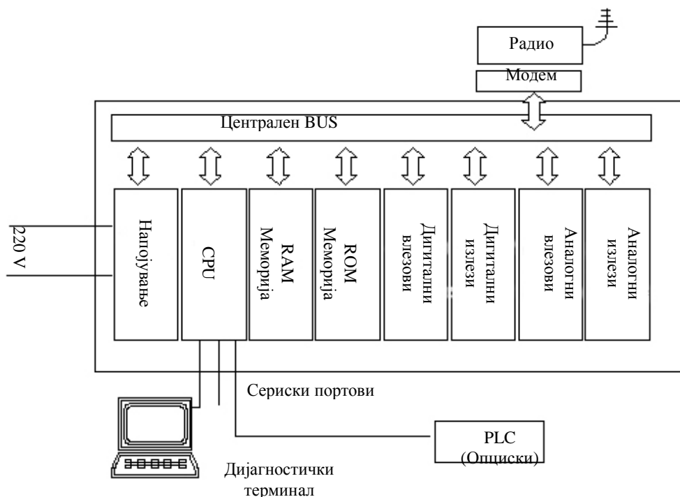
Слика 2.24: Функционален распоред на хардверот во една RTU единица [34]
