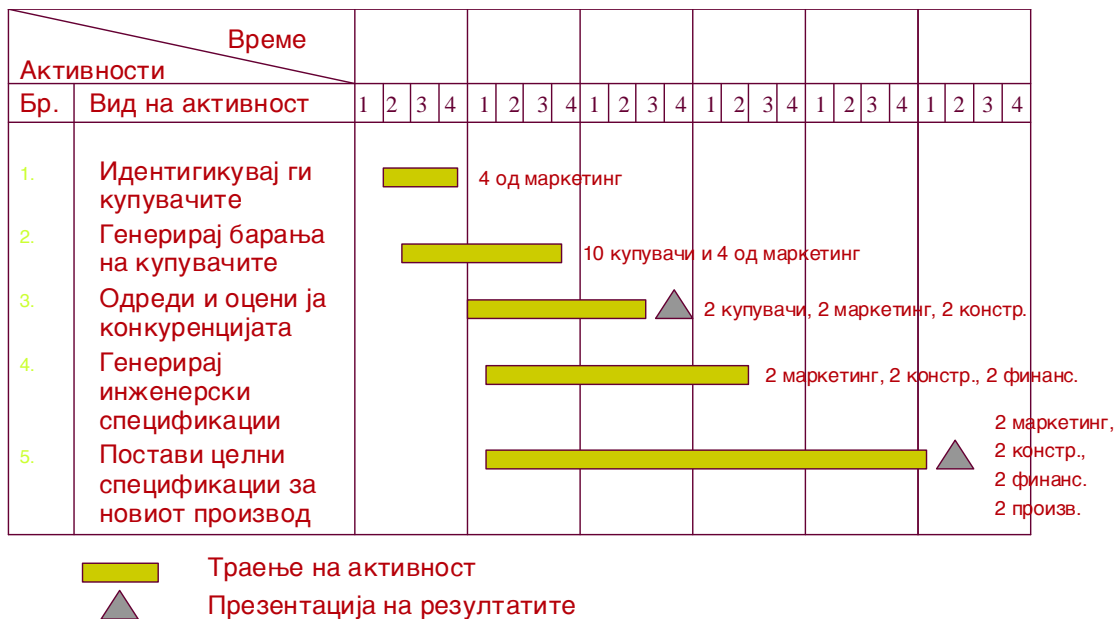
Сл. 5.1. Пример на Gantt дијаграм за фазија на изработка на инженерскиите спецификации
