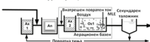
Слика 6.24. Процеси со активна тиња за отстранување на фосфорот [2]
