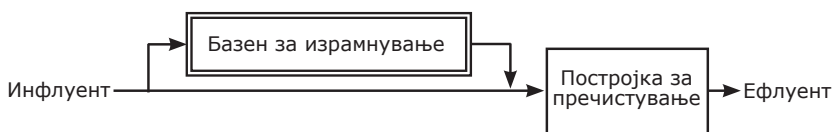
Слика 10.3. Систем за израмнување со повремено пренасочување на протокот
