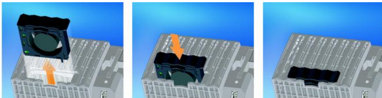
Слика 5.4 – Замена на вентилаторот кај Celeron 650 процесорите
