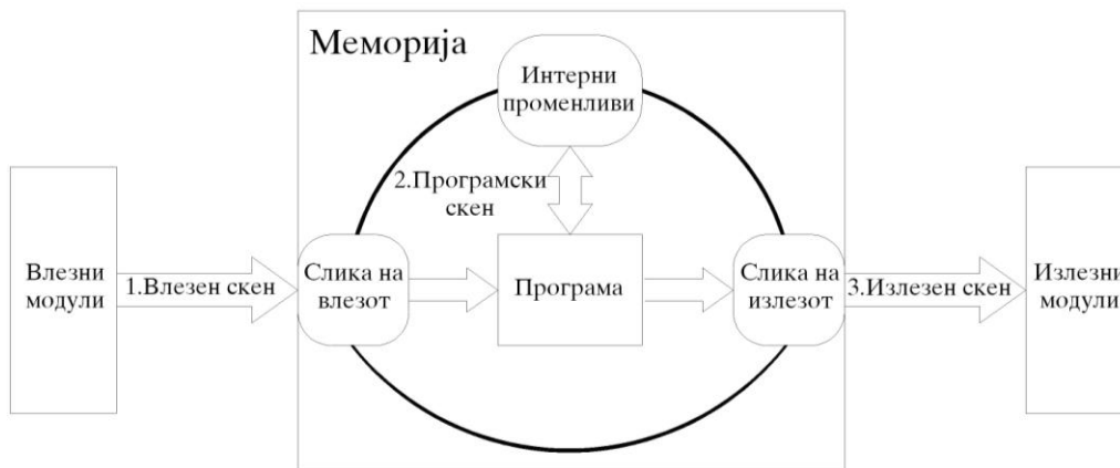
Слика 2.10: Движење на информација во работен циклус на PLC-то
