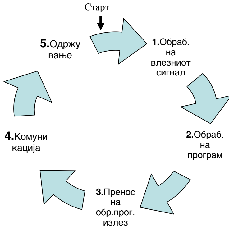
Слика 2.9: Работен циклус на PLC-то
