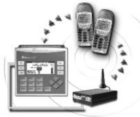
Слика 3.2: Поврзување на PLC со GSM модем
