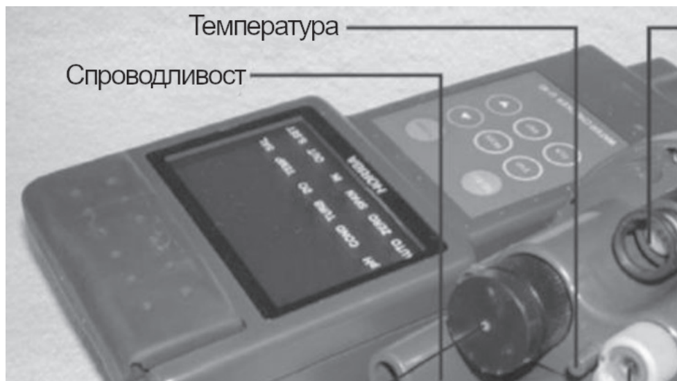
СЛИКА 44: Мулти параметарска сонда за мерење физичко-хемиски параметри на водата (Horiba Ltd., 2012).
