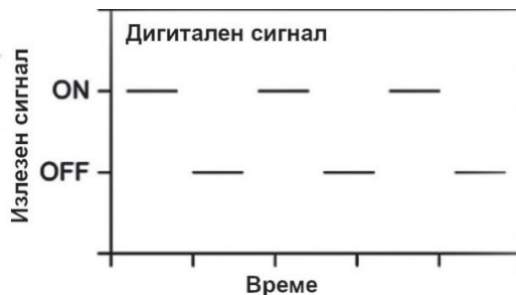
СЛИКА 6: Дигиталните излезни сигнали флукутираат помеѓу две дискретни нивоа, како што се вклучено/исклучено или високо/ниско.
