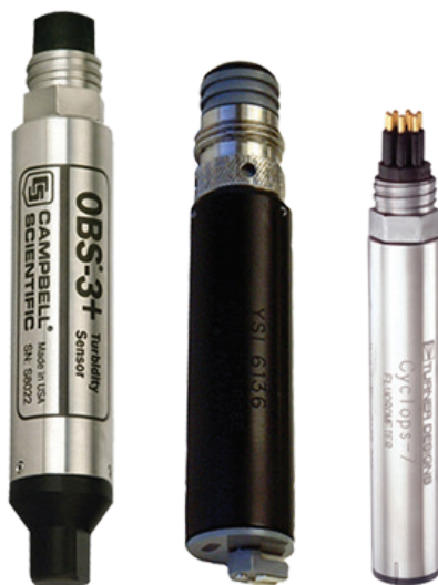
СЛИКА 41: Потопни сензори за динамичко мерење на заматеност за мониторинг во реално време.
