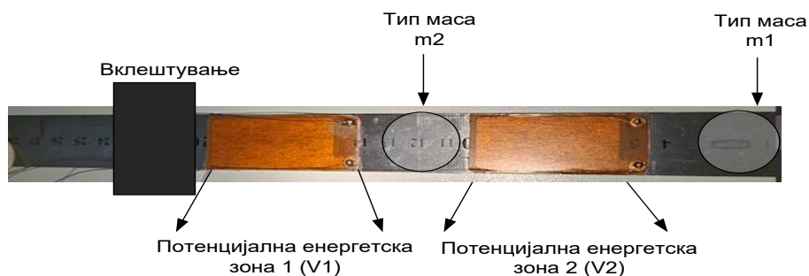
Слика 5.4: Локации на поставување на додадените маси m_1 и m_2 , позициите на интегрираните пиезоелектрични претворувачи и енергетските зони 1 и 2
