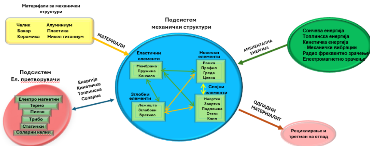
Слика 4.3. Структурна поставеност и меѓусебна поврзаност на подсистемот на механички структури во мултифизичкиот систем
