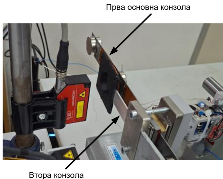
Слика 5.19: Експериментална конфигурација со намотка интегрирана на втората конзола за зголемување на релативното движење помеѓу магнетот и намотката.
