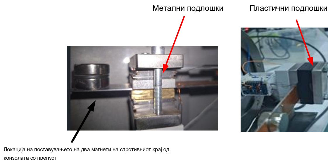
Слика 5.7: Подобрување на конекцијата со вкештувањето и дополнителни магнети
