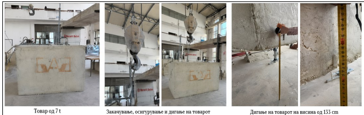
Слика бр. 4.8 Приказ на товарот од 7 t и негово закачување, осигурување и дигање
