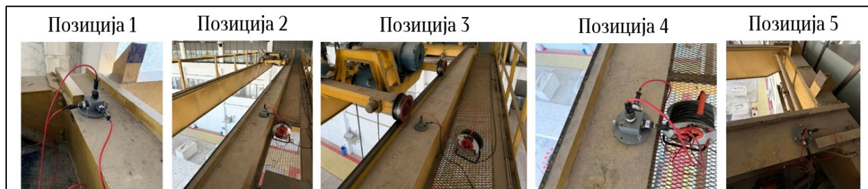
Слика бр.4.5 Позиции на акцелометрите (1, 2, 3, 4 и 5)
