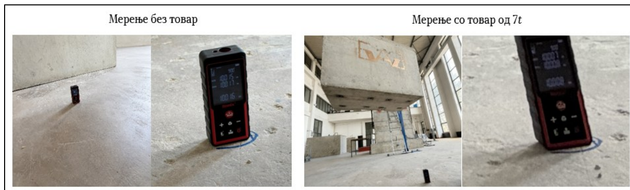
Слика бр.4.10 Мерење на растојание од подлогата до долната страна на главниот носач без товар и со товар од 7t
